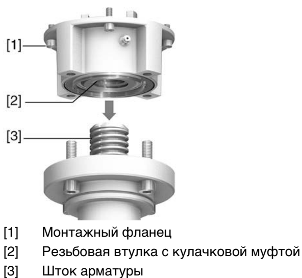
рис. 9: Установка втулки А
